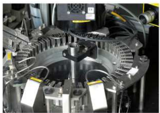
微調式分度盤 (免換分度盤) Adjustable Rotary Disc
