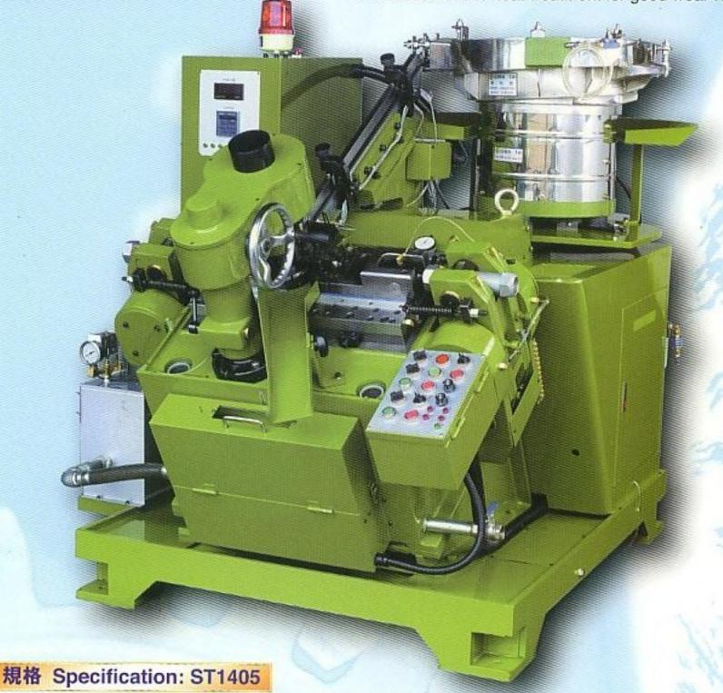
傳動方式 Transmission 日内瓦機械 Geneva organization 馬力 Horsepower 10HP(雙頻器Inverter) 使用馬達 Motor applied 7.5HP(6P) 速度 Speed 120~450 rpm (MAX:500) PLC 可程式控制(Program Logical Control) 控制方式 Control LED 故障顯示(Light Emitted Display) 制造能力 Production ability dieo2.8~5.2 (#6~#14) length 9.5~125 mm L1900 × W1400 × H1600 mm 外觀尺寸 Dimension (LXWXH) 機械重量 Machine weight 2200 kg
