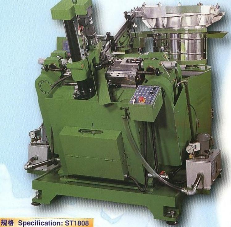
傳動方式 Transmission 雙凸輪傳動 Twin cams 送料定位方式 Feeding/positioning 分割器 Index 馬力 Horsepower 15HP(雙頻器Inverter) 使用馬達 Motor applied 10HP(6P) 速度 Speed 45~250 rpm PLC 可程式控制(Program Logical Control) 控制方式 Control LED 故障顯示(Light Emitted Display) dieø2.8~7.0 (#6-#18) length 10~200 mm 制造能力 Production ability (Max.370mm 特别定制 For Special Order) L1850xW1950xH1850 mm 外觀尺寸 Dimension (LXWXH) 機械重量 Machine weight 3500 kg
