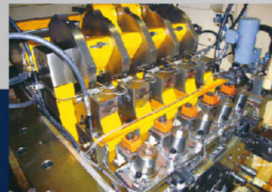
New mechanism allows for P.K.O. adjustment. 可變3段行程前通出機構(P.K.O.)，方便模具設計及調整 (選配)
